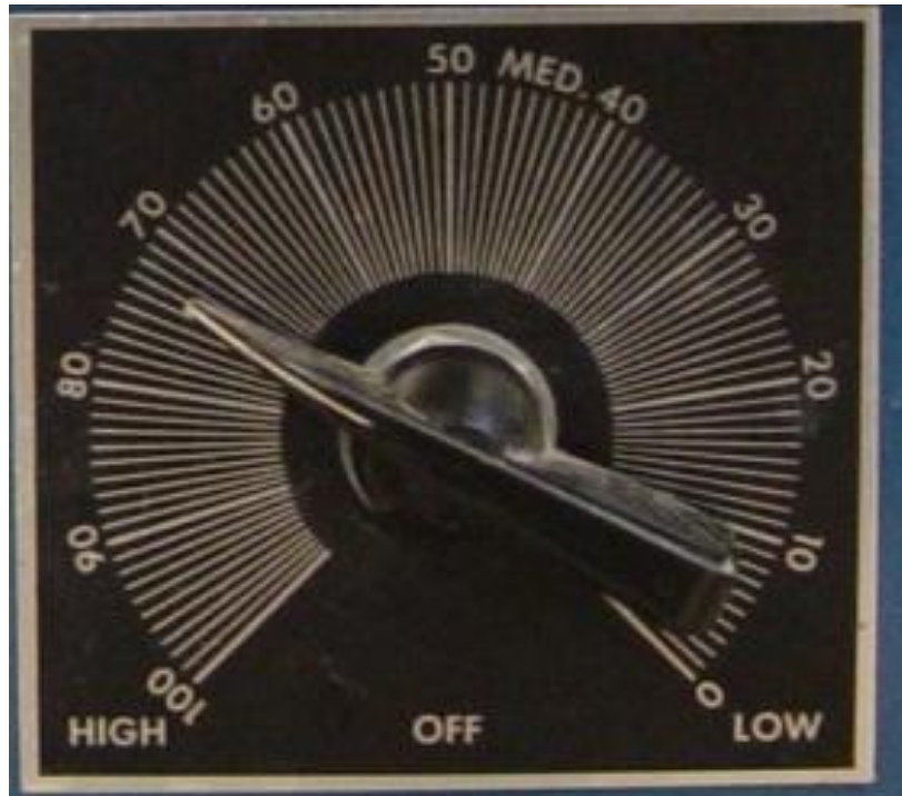
Bild 7: Leistungsregler – manchmal sehen die auch anders aus, sind aber meist mit High und Low beschriftet.
