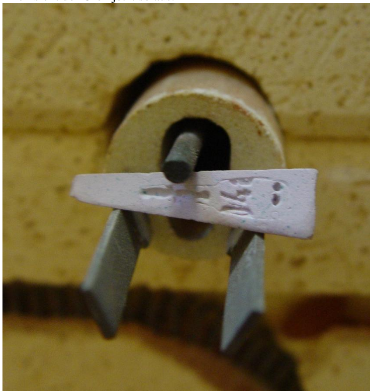
Bild 5. Ofen mit eingelegetem Kegel
