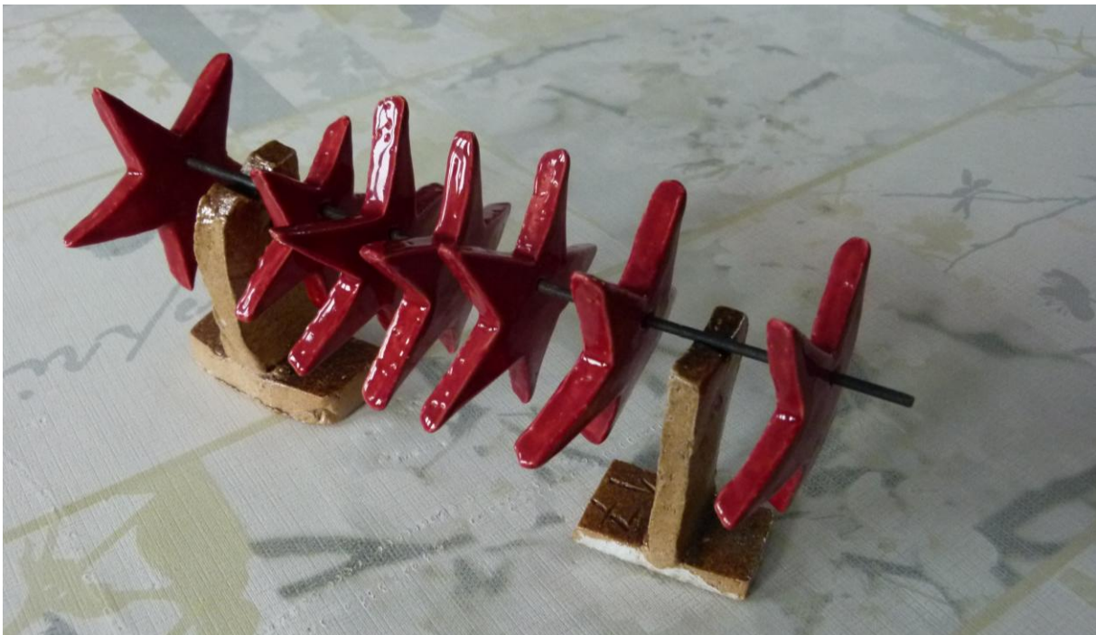
Abbildung 8: Das ist ein 4mm- Kanthaldraht, die Sterne sind ca. 5 cm groß und 3 mm dick, das geht bei 1060°C gerade noch so.
